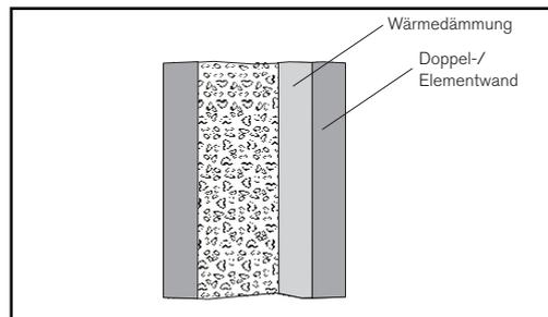
Doppel-/Elementwand mit Wärmedämmung und Außenabdichtung
