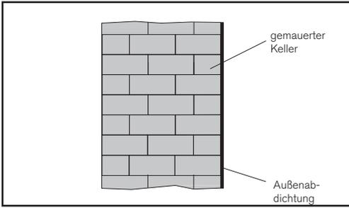
Gemauerter Keller mit Außenabdichtung nach DIN 18195-6
