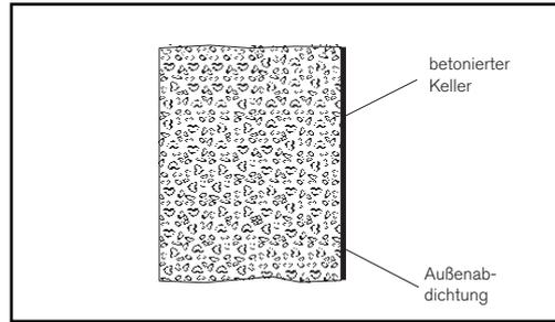
Betonierter Keller mit Außenabdichtung nach DIN 18195-6
