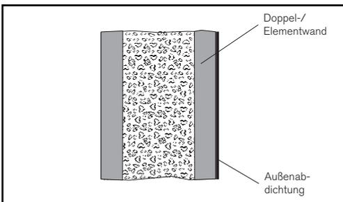
Doppel-/Elementwand mit Wärmedämmung
