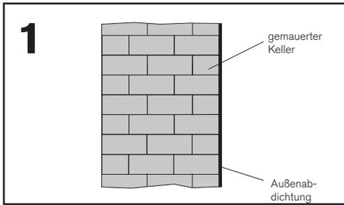
Gemauerter Keller mit Außenabdichtung nach DIN 18195-6
