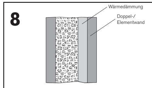
Doppel-/Elementwand mit Wärmedämmung und Außenabdichtung
