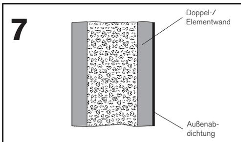
Doppel-/Elementwand mit Wärmedämmung
