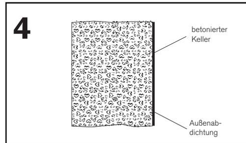
Betonierter Keller mit Außenabdichtung nach DIN 18195-6
